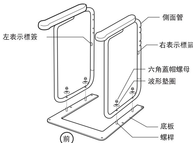
側面管插入底板螺桿後，再使用六角扳手把波形墊圈和六角蓋帽螺母鎖緊。
